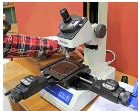
Die Wegmesssysteme des Kreuztisches dieses Messmikroskops haben eine Auflösung von 1 µm (Foto: Klaus Vollrath)
